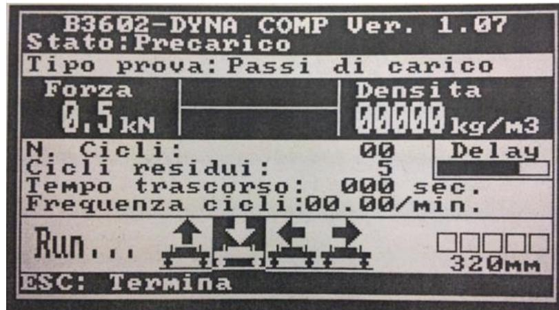
Figura 1.11. Schermata per l'avvio ed il monitoraggio della prova
