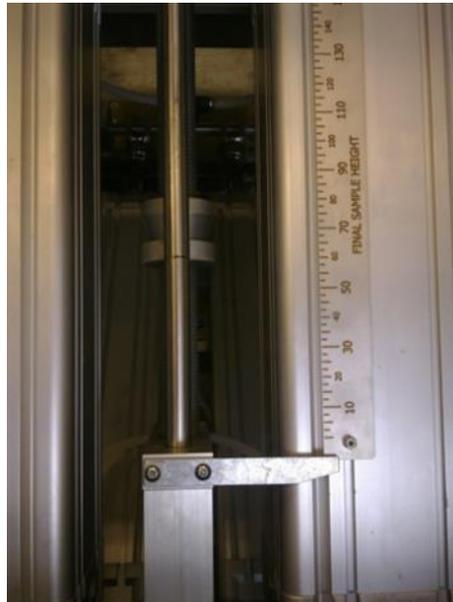
Figura 1.10. Corsore per la regolazione dello spessore finale della lastra
